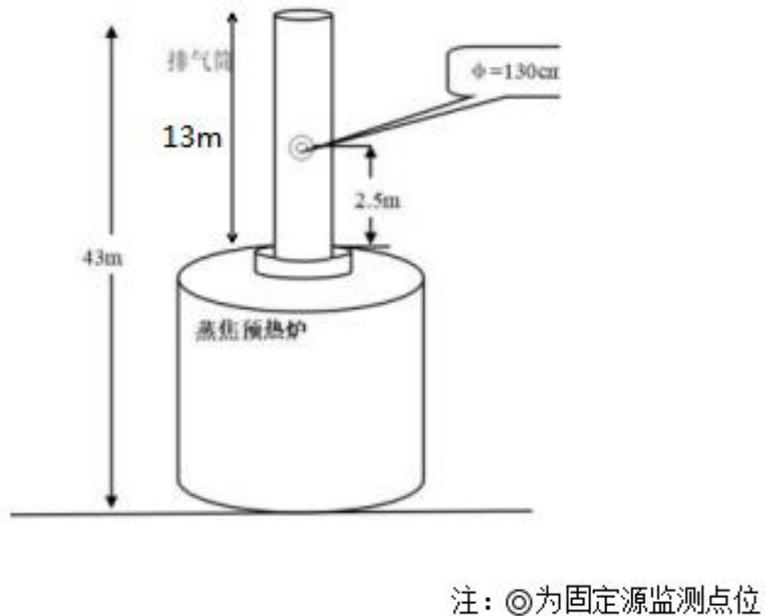
附图 4 预热炉废气排放口监测点位示意
